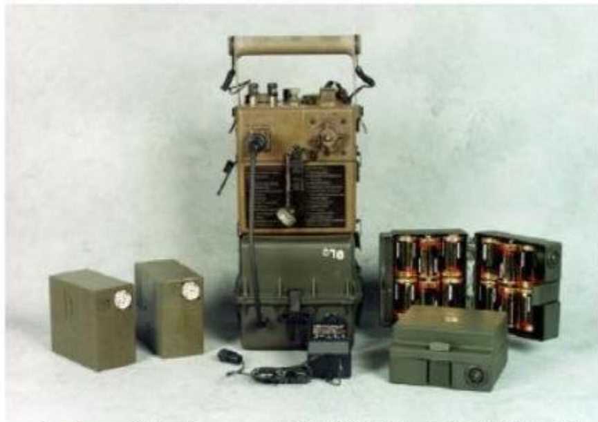
圖五 美國M8A1型電化學毒氣警報器
