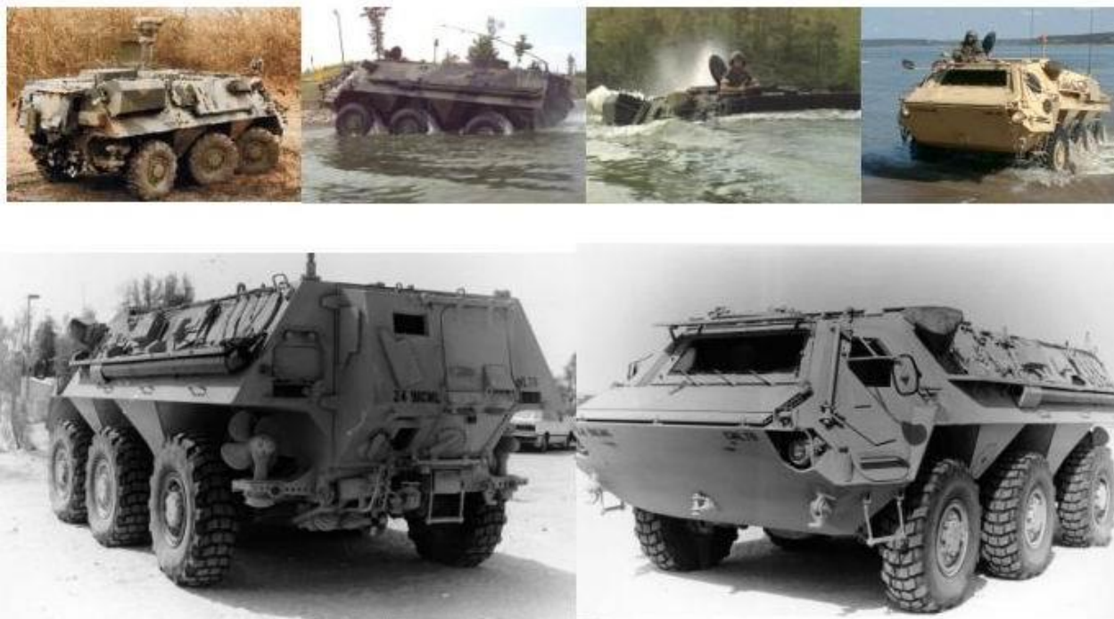
圖十 美國“狐”式M93A1生化偵檢車
