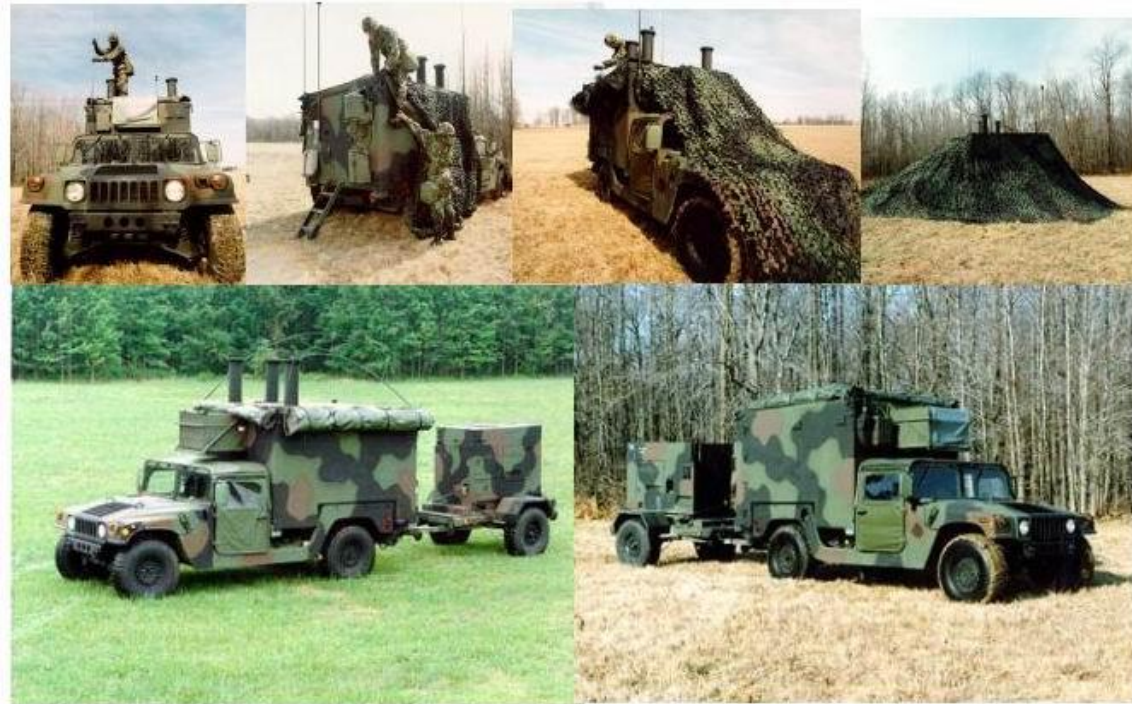
圖十二 美國M31E1核生化偵檢車
